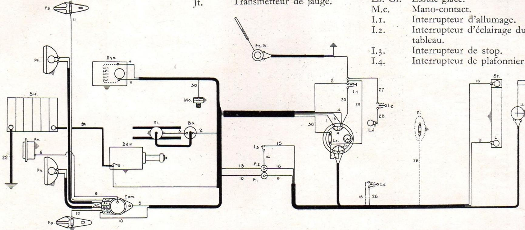
Fig. 33. — Schéma de l'installation électrique.
